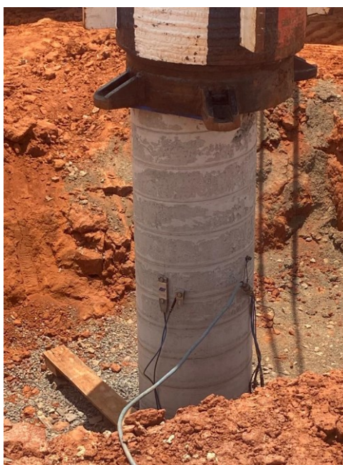
Figura 5- Ensaio de Prova de Carga Dinâmica na região de estudo
