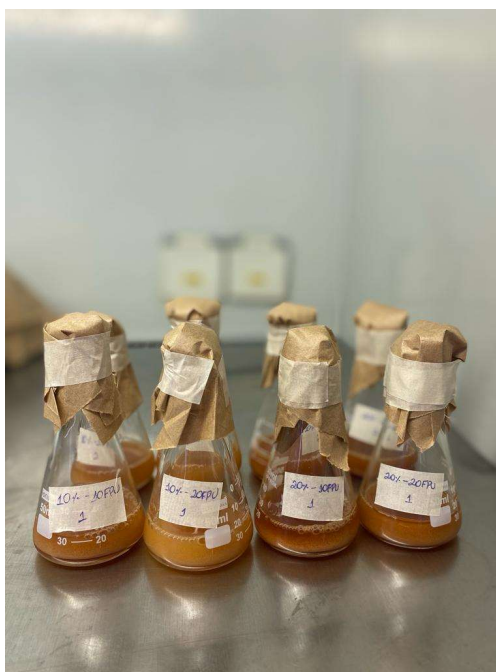
Figura 10 – Erlenmeyer contendo o mosto
