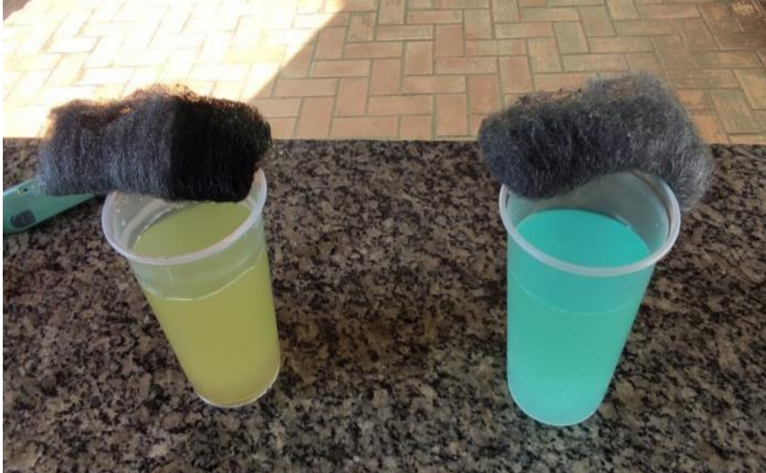
Figura 10. Produto da empresa concorrente na esquerda com oxidação ocorrida na esponja e produto com fonte quelado na direita, sem apresentar problemas
