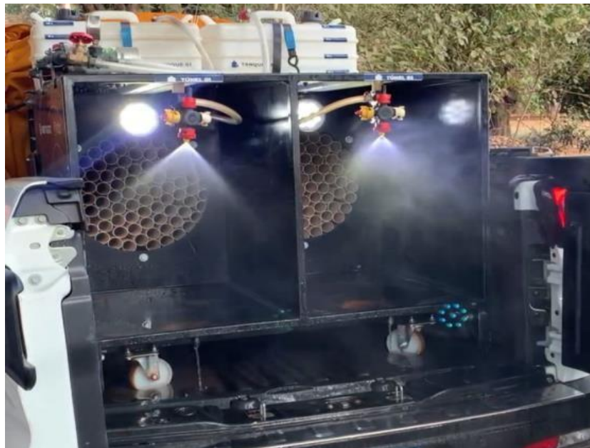
Figura 7. Simulador de deriva testando o adjuvante antideriva da empresa contra um concorrente
