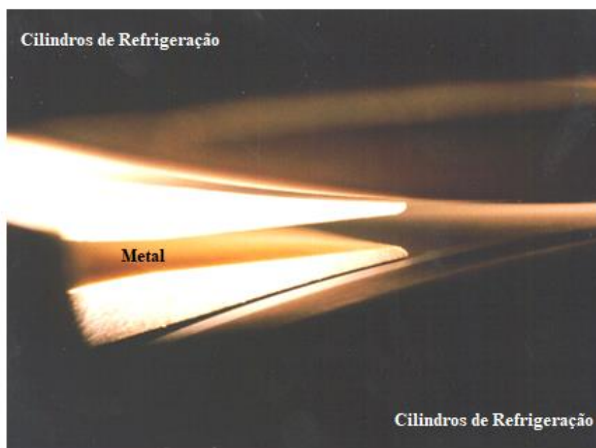
Figura 23 – Solidificação do metal entre os cilindros de refrigeração.
