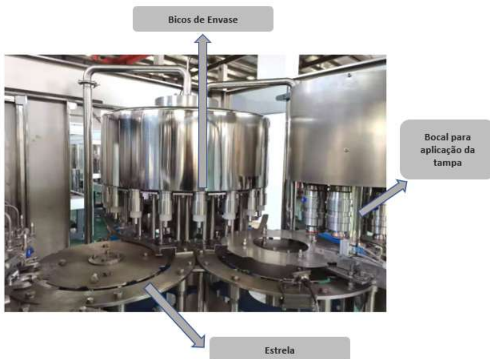
Figura 4.2 – Módulo interior do equipamento de envase Ronchi Exacta.
