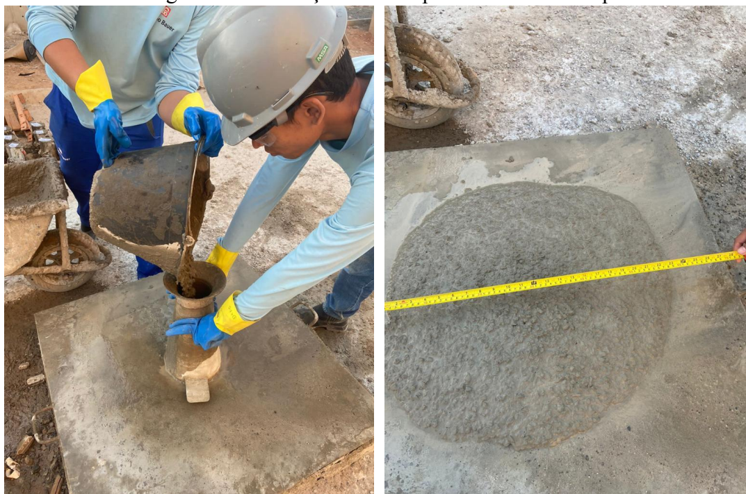
Figura 5 – Realização do Slump Flow Test em campo.
