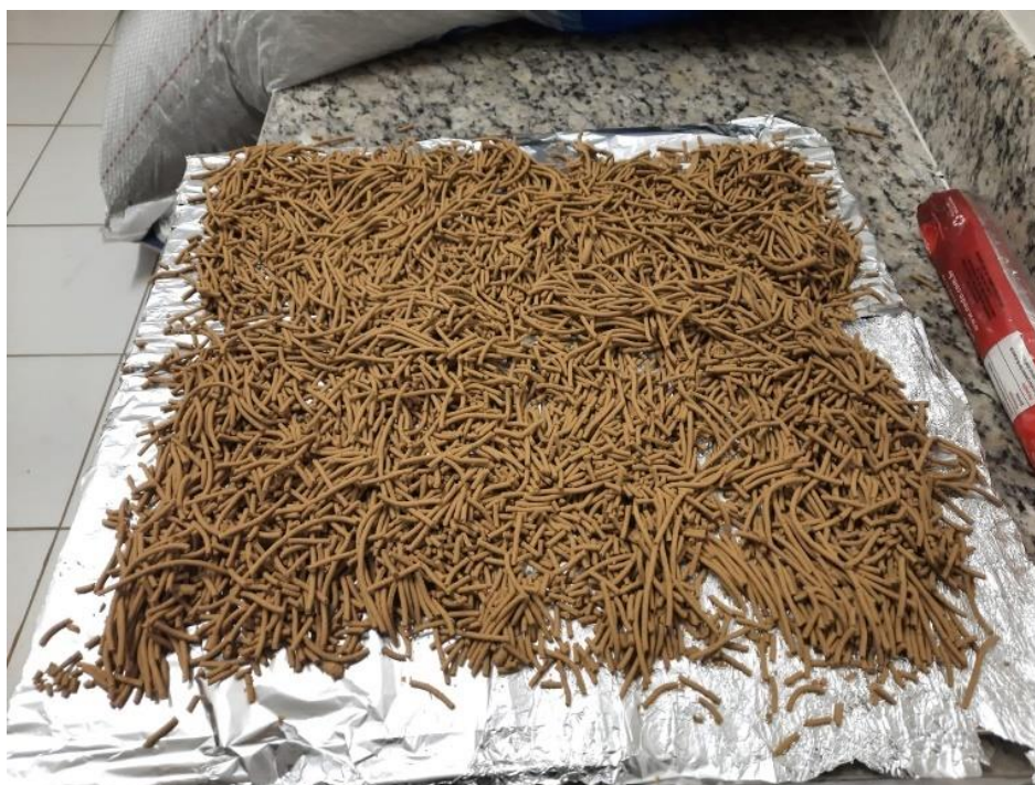
Figura 18. Preparação para secar em estufa por 24 horas
