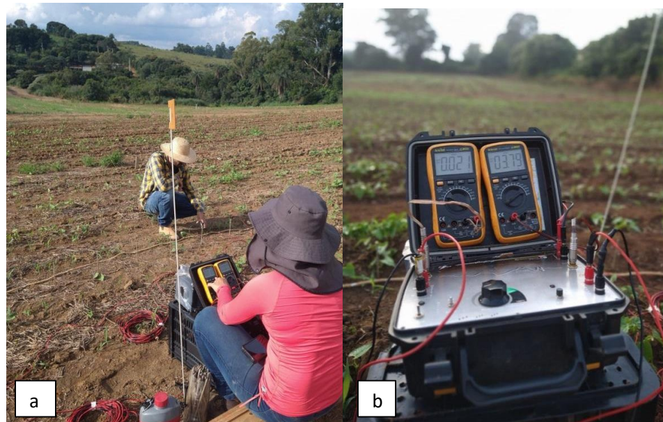
a: Coleta de dados de REs na Fazenda experimental Muquem UFLA; b: Modelo de resistivímetro utilizado (Alta Energia modelo X5xtal 250). Fonte: Do autor (2022)
