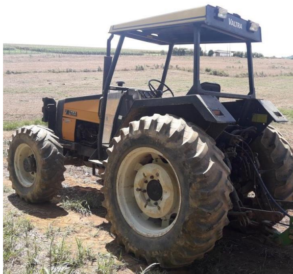
Figura 5 - Trator utilizado para realizar a compactação adicional do solo
