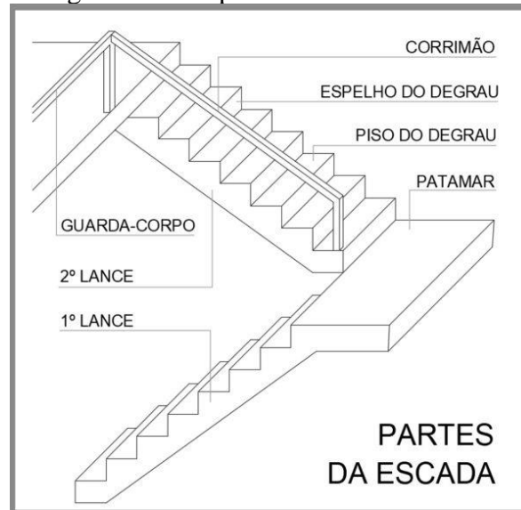
Figura 6 - Componentes de uma escada.
