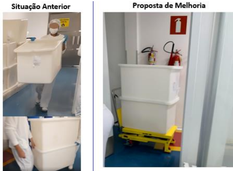
Figura 10 – Melhoria aplicada no transporte das banheiras.
