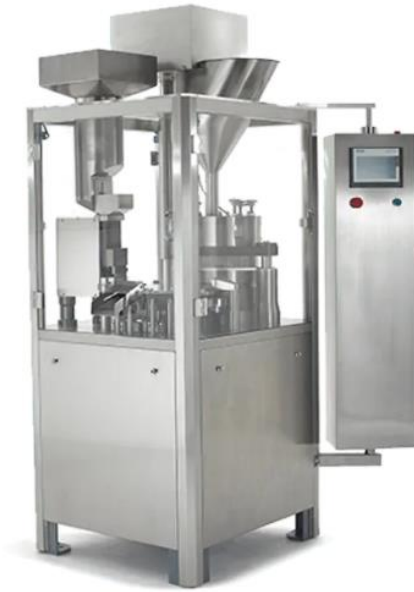
Figura 33 – Máquina de enchimento automático de cápsulas.
