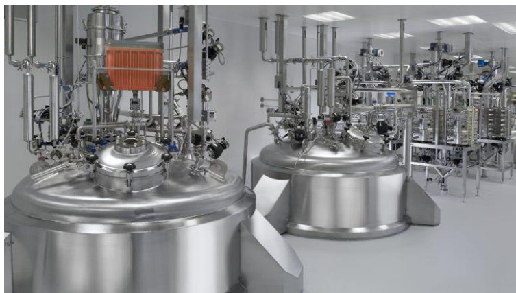
Figura 14 – Reatores em batelada utilizados para síntese química em indústrias farmacêuticas.
