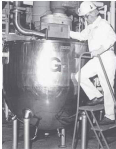
Figura 34 – Tanque de aço inox com agitação planetária.
