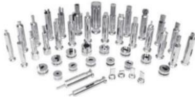
Figura 29 – Diferentes punções e matrizes utilizadas no processo de formação de comprimidos.
