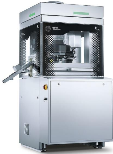
Figura 31 – Exemplo de prensa rotatória para compressão.
