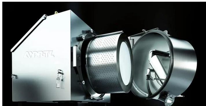
Figura 21 – Centrífuga peeler horizontal para aplicações farmacêuticas.
