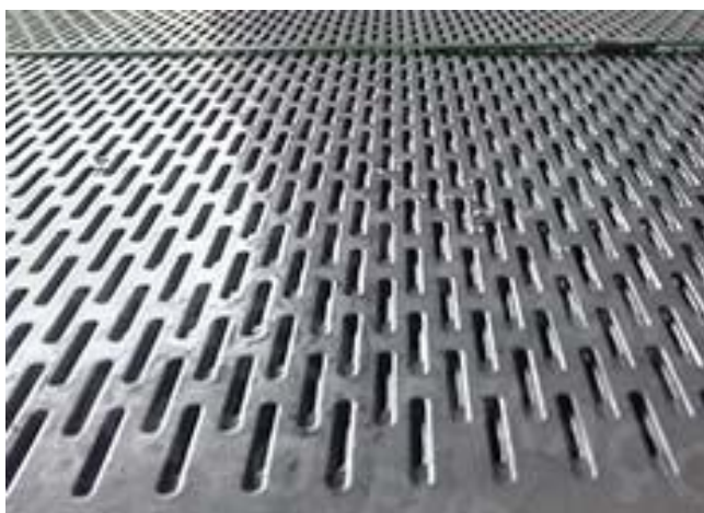
Figura 15: Chapa perfurada com furos oblongos.
