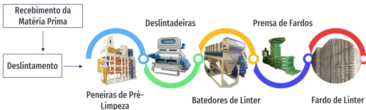
Figura 12: Etapas do processo de produção dos fardos de linter.
