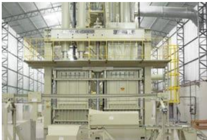
Figura 7: Prensa hidráulica para enfardamento de algodão.
