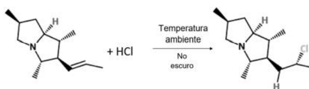
Figura 11: Equação global da reação de adição na insaturação da molécula.
