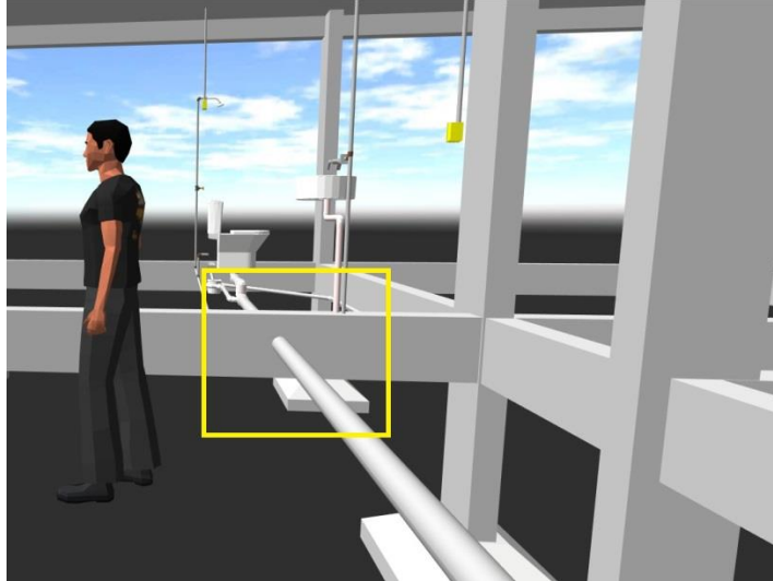
Figura 20 – Incompatibilidade entre o projeto estrutural e o hidrossanitário.
