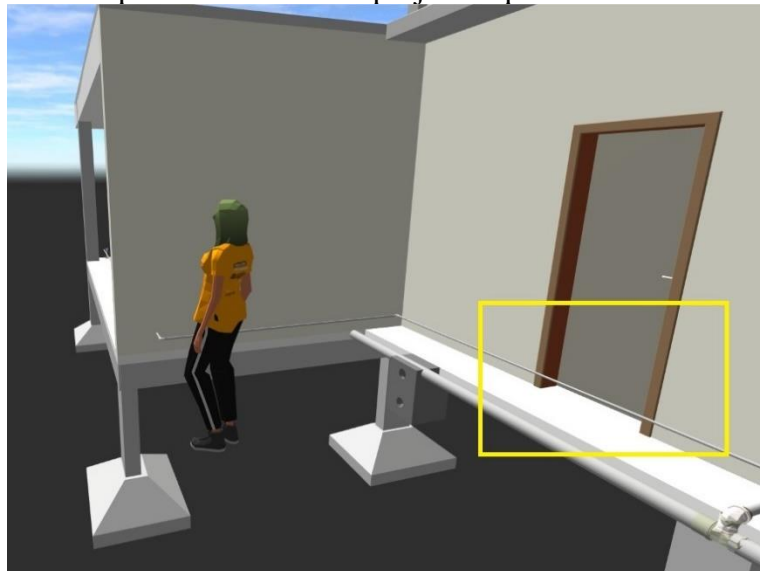
Figura 19 – Incompatibilidade entre o projeto arquitetônico e o hidrossanitário.
