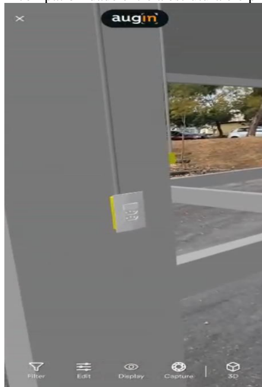
Figura 23 – Incompatibilidade entre a estrutura e o projeto elétrico
