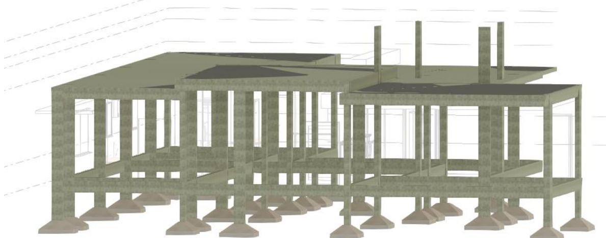
Figura 6 – Vista 3D do projeto estrutural modelado.
