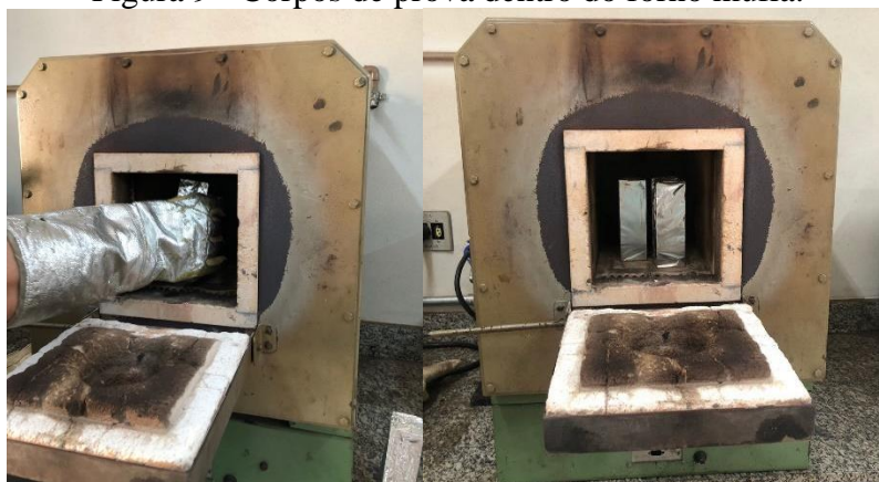
Figura 9 - Corpos de prova dentro do forno mufla.
