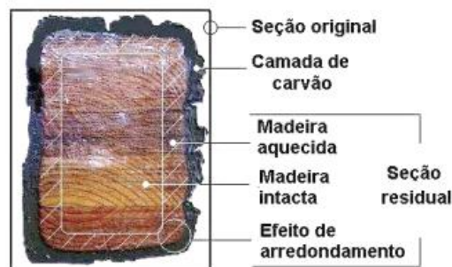
Figura 2 - Esquemática das camadas de uma peça de madeira quando exposta à altas temperaturas.
