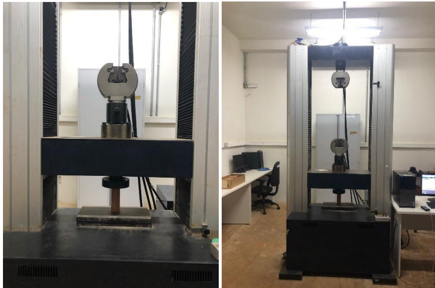
Figura 11 - Corpo de prova submetido ao ensaio de compressão na Máquina Universal de Ensaio.
