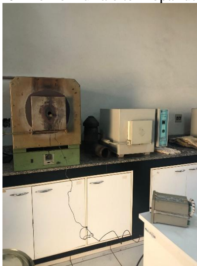
Figura 10 - Forno mufla e termopar utilizados.
