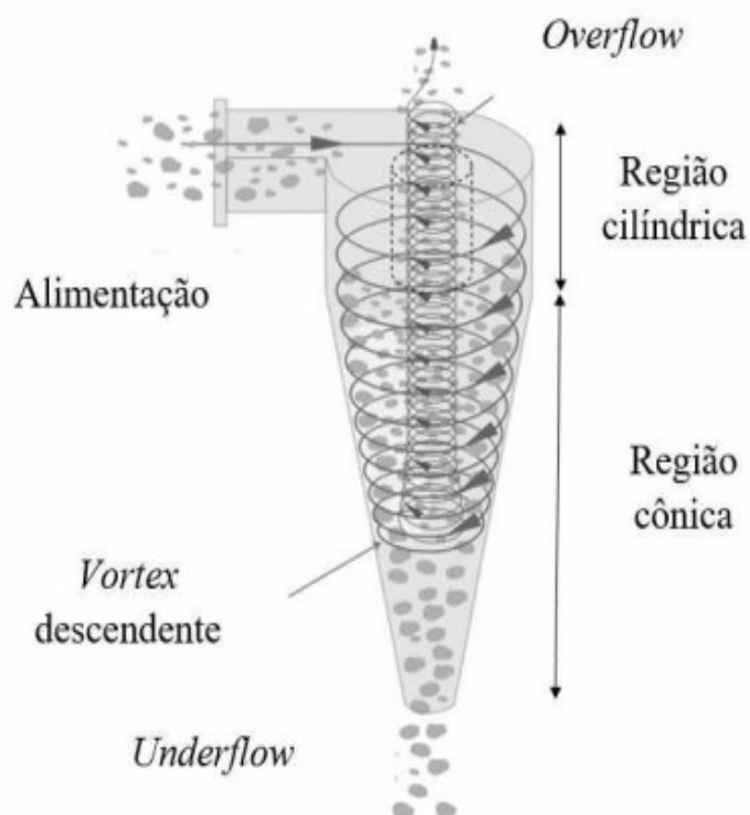
Figura 14 - Representação do funcionamento de um hidrociclone.
