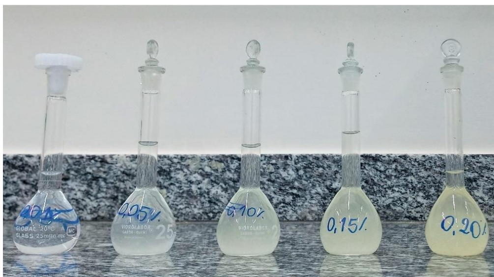
Figura 6 — Soluções para calibração do ensaio de liberação controlada
