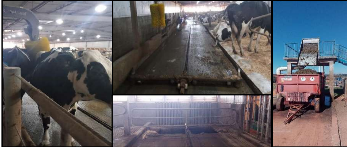
Figura 4 – Vacas em escova giratória (A). Raspador automático em funcionamento (B). Fosso de dejetos (C). Peneira de separação de dejetos (D).
