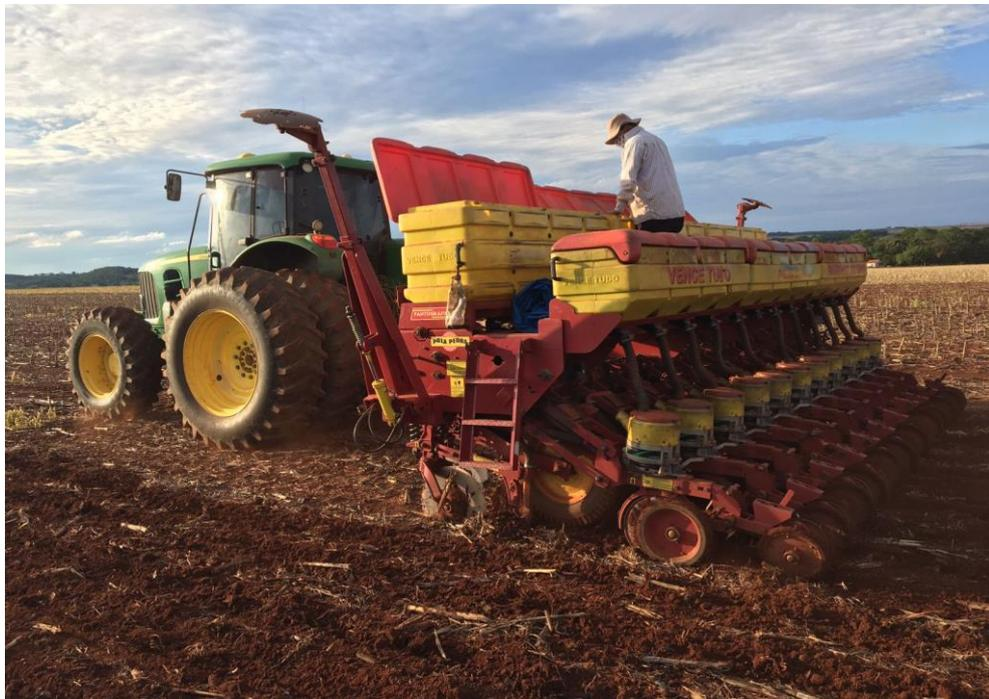
**Fig. 15:** Regulagem de semeadora Panther Vence Tudo. Fertilizante Max 250 e semente BMX FOCO IPRO
