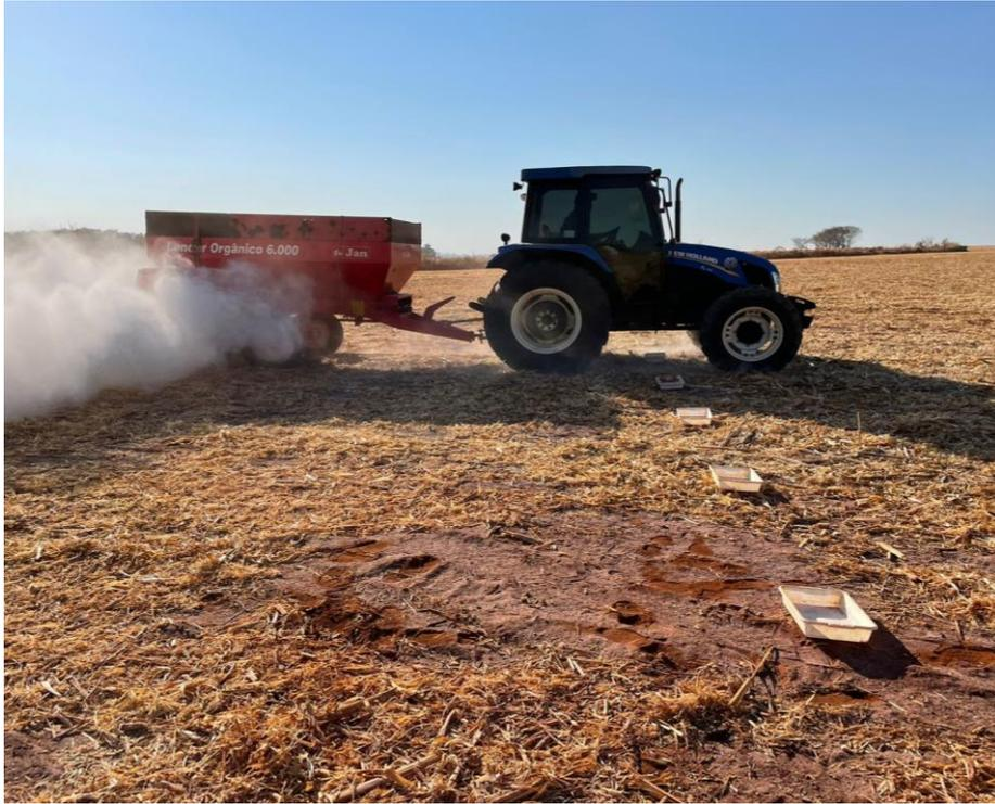
**Fig. 3:** Regulagem de faixa de aplicação para distribuidor de calcário utilizando Jan Lancer Orgânico 6.000
