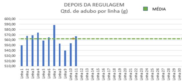
Fig. 16: Quantidade de adubo (em gramas) por linha no espaço de 50 metros e quantidade de fertilizante por hectare antes e após a regulagem.
