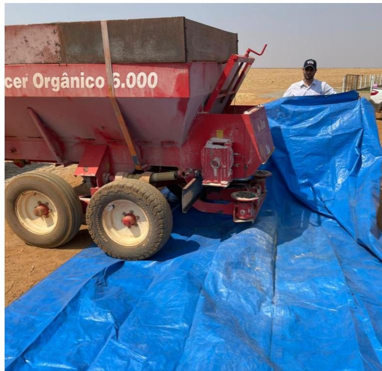
**Fig. 4:** Regulagem de taxa de aplicação para calcário utilizando Jan Lancer Orgânico 6.000.
