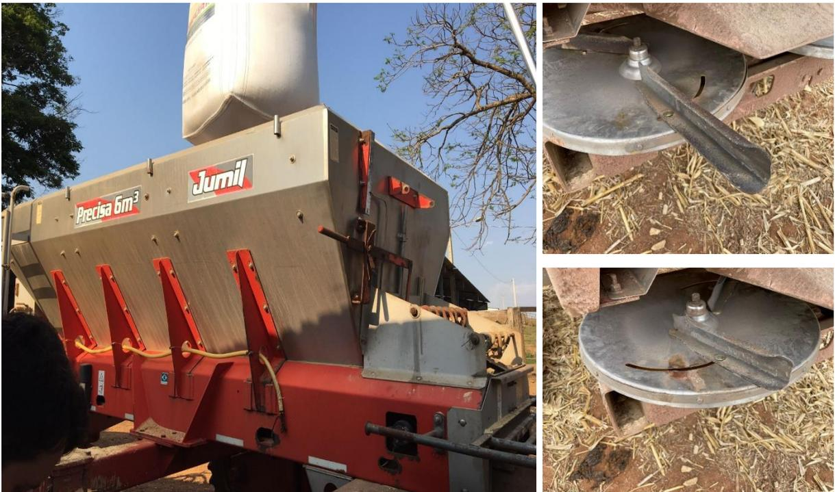
**Fig. 13:** Regulagem de faixa e taxa de aplicação para Cloreto de Potássio (KS-63) utilizando o implemento Jumil Precisa 6m<sup>3</sup>.
