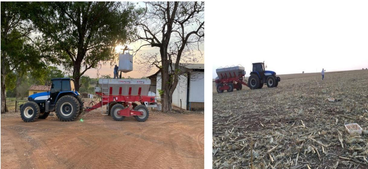
**Fig. 14:** Regulagem de faixa e taxa de aplicação para Cloreto de Potássio (KS-63) utilizando o implemento Jumil Precisa 6m<sup>3</sup>.
