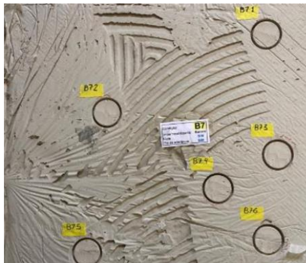
Figura 13 - Distribuição dos corpos de prova para a condição B7 antes da colagem das pastilhas metálicas.
