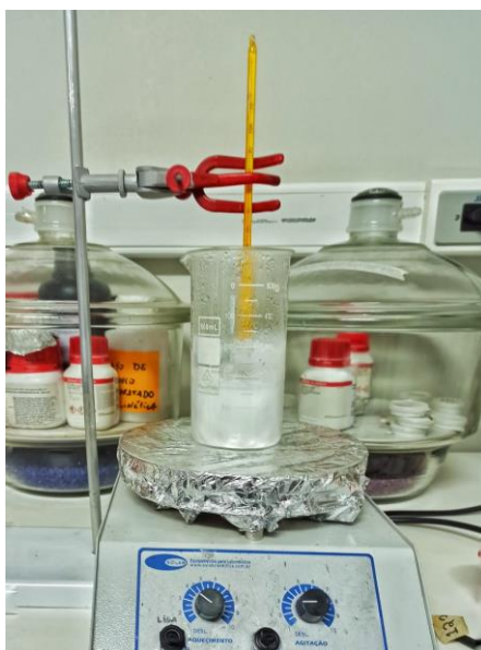
Figura 5 - Solução para obtenção de ZnO em agitação magnética e aquecimento.
