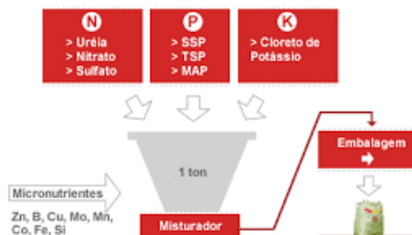
Figura 15 - Fluxograma simplificado de mistura de fertilizantes.
