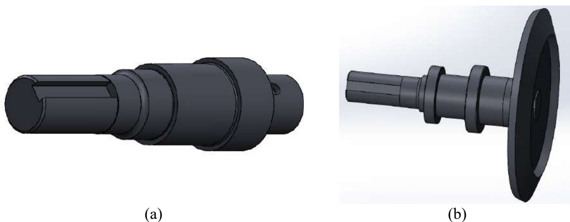
Figura 4.23 – Eixo da coroa cônica final.
