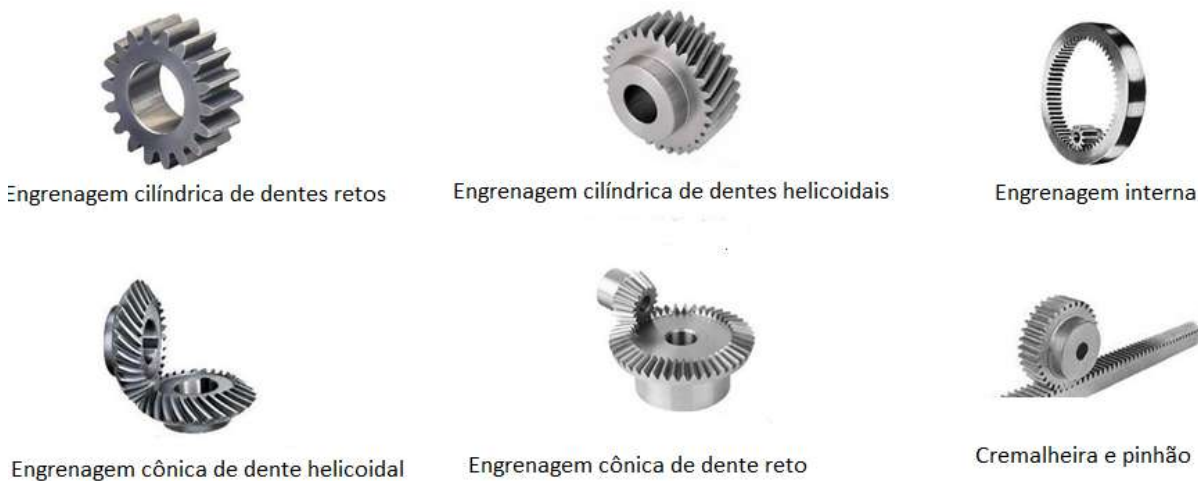
Figura 2.9 – Tipos de engrenagens convencionais.
