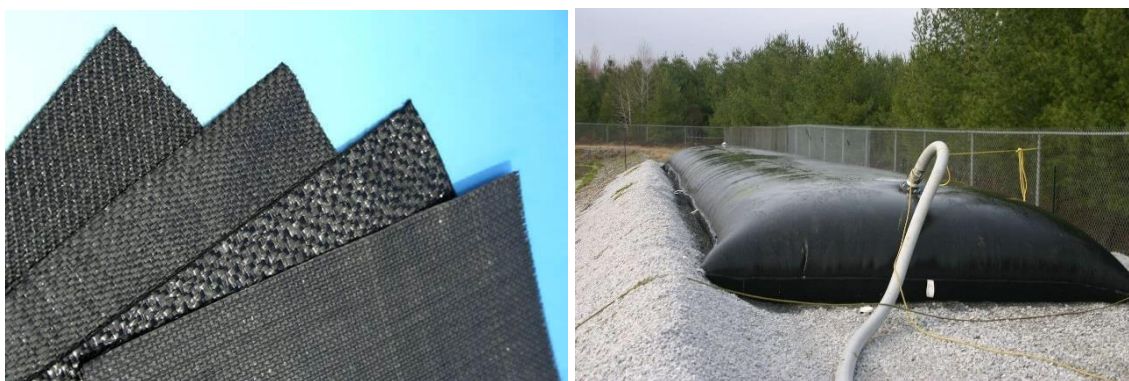
Figura 4- Bolsa geotêxtil de desidratação de lodo em pátio de desidratação.
