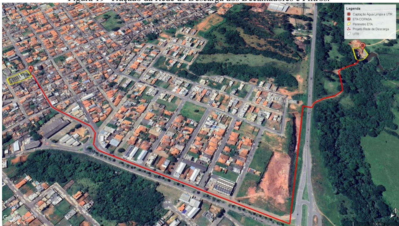
Figura 19- Traçado da Rede de Descarga dos Decantadores e Filtros.
