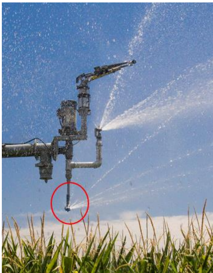
Figura 5. Emissor R55i VT (circulando) em operação conjunta com R55.
