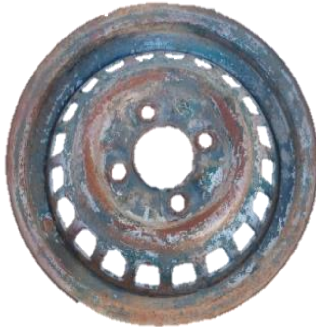
Figura 21 - Oxidação presente no corpo de prova
