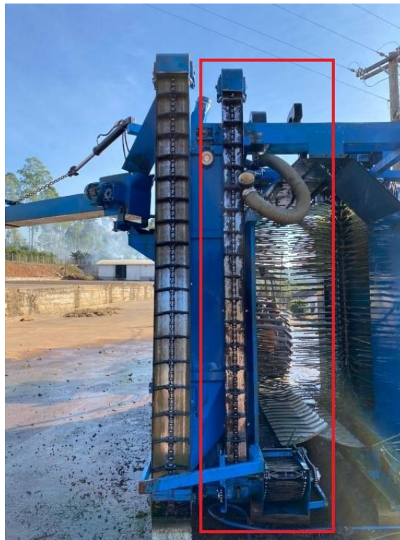
Figura 1: Elevador de frutos da colhedora com a tampa dos dois elevadores abertas.
