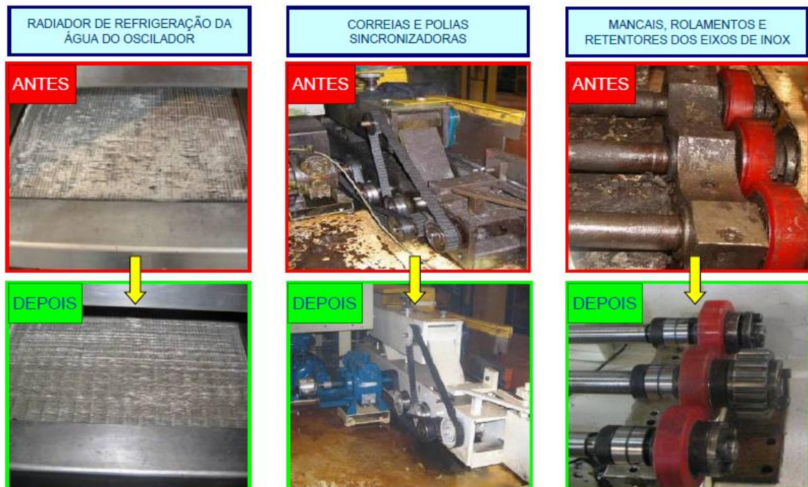
Figura 11: Eliminação da deterioração acelerada nos componentes.
