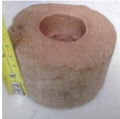
Figura 2- Briquete confeccionado a partir de pó de MDF.
