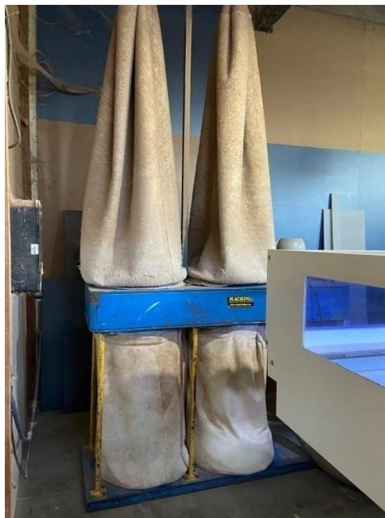
Figura 8- Exaustores responsáveis por deter e armazenar o pó gerado no processo de corte.
