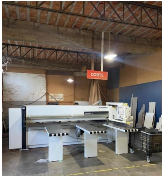
Figura 3- Maquinário responsável pelos cortes das chapas na “A”.
