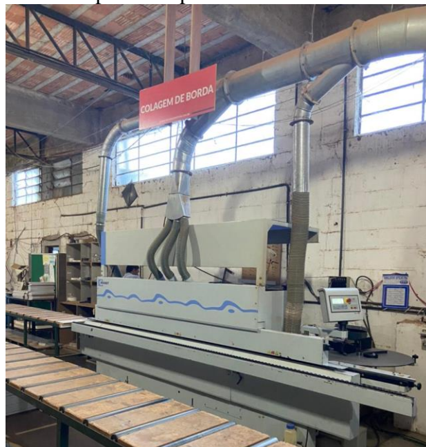
Figura 4 - Equipamento responsável por colar as fitas de borda nas peças de MDF.
