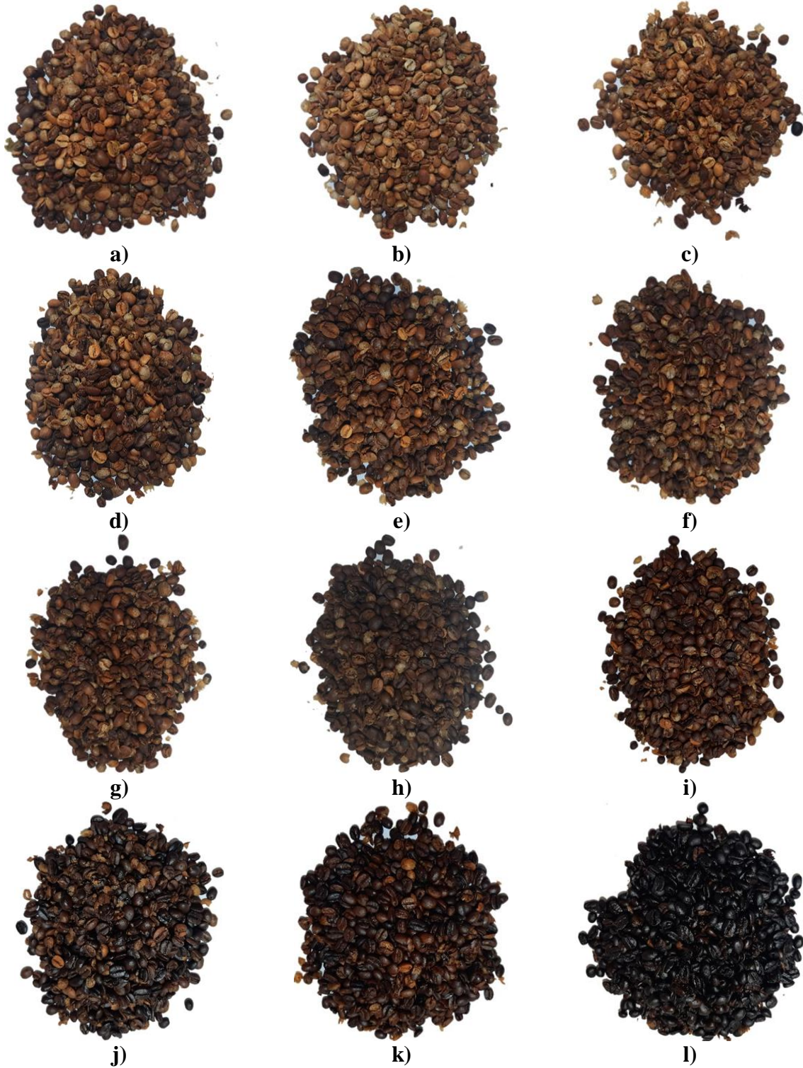
Figura 29 - Amostra de 100g em grão torrada por a) 1 minuto e 40 segundos; b) 2 minutos; c) 2 minutos e 30 segundos; d) 3 minutos; e) 3 minutos e 30 segundos; f) 4 minutos; g) 4 minutos e 30 segundos; h) 5 minutos; i) 5 minutos e 30 segundos; j) 6 minutos; k) 6 minutos e 30 segundos; l) 7 minutos.
