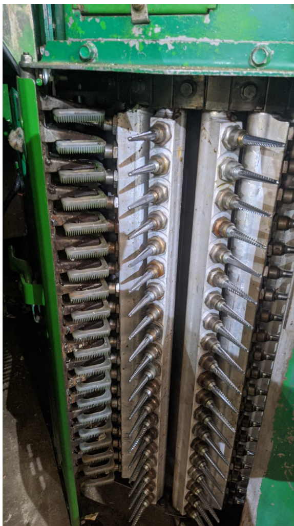
Figura 2.5 – Fusos recolhedores montados na máquina.
