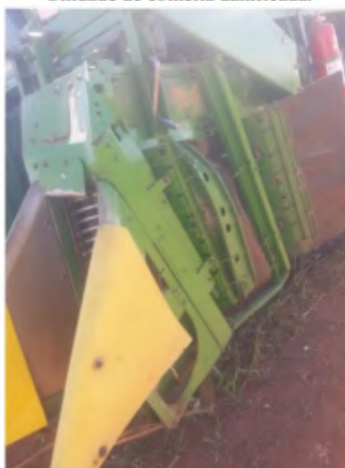
Unidade de colheita danificada.
