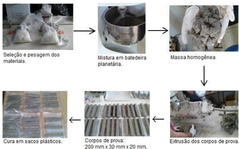
Figura 5 - Esquema de produção dos compósitos extrudados.
