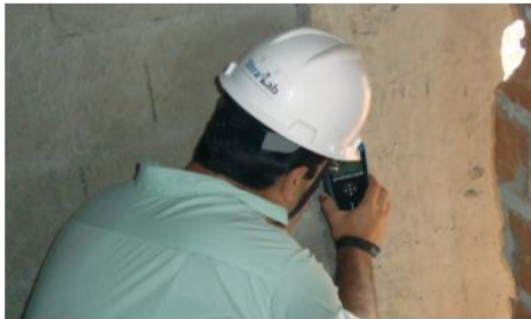
Figura 13 – Ensaio de pacometria
