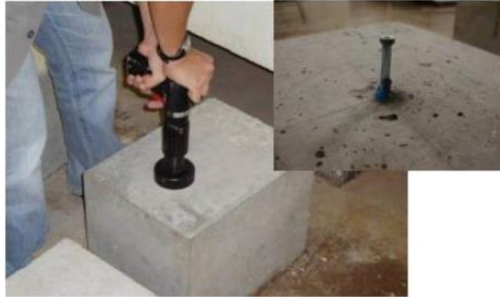
Figura 14 – Ensaio de penetração de pinos
