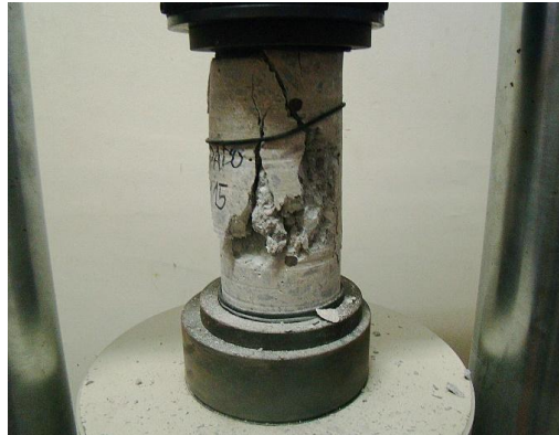
Figura 19 – Ensaio de Resistência à compressão
