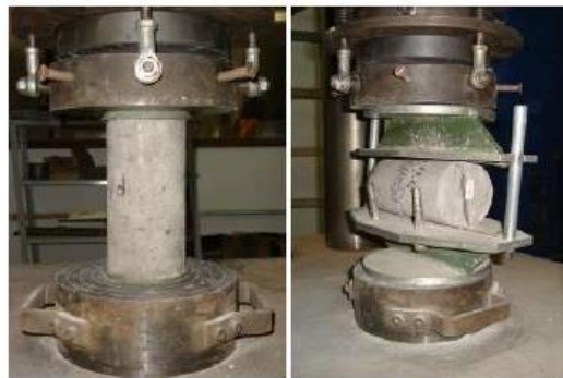
Figura 20 – Ensaio de resistência à tração
