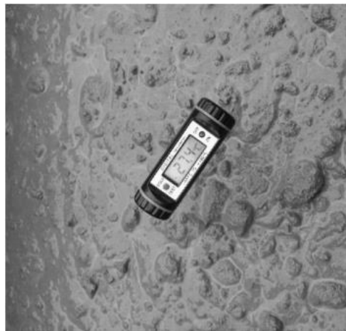
Figura 11 – Utilização de termômetro digital na superfície para leituras
