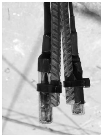
Figura 12 – Sensores que ficam ligados ao termômetro
