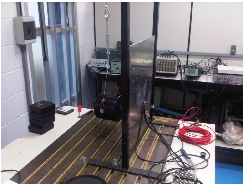
Figura 5.2 – Setup do teste modal experimental utilizando shaker .
