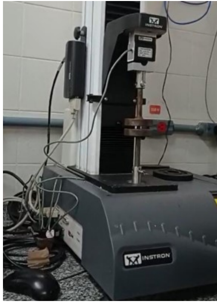
Figura 42: Ensaio de compressão
