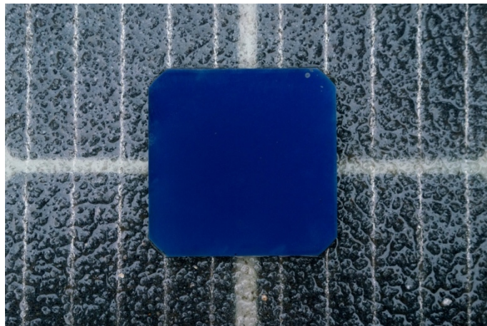
Figura 22: Silício azul, componente gerador de eletricidade dos painéis solares
