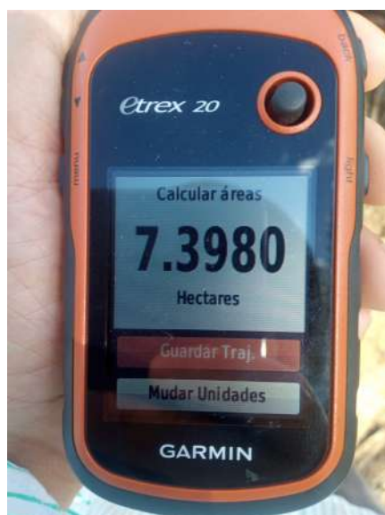
Figura 4.28 – Aparelho receptor de GPS Garmin utilizado para a medição de áreas
