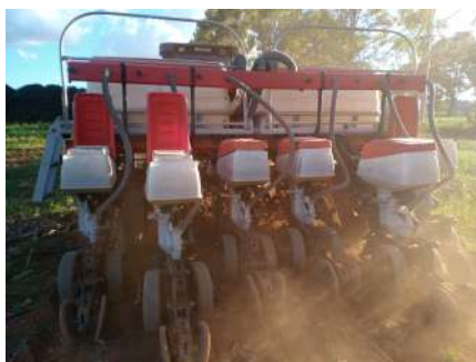
Figura 4.31 – Verificação da regulagem de semeadora-adubadora pneumática no campo.
