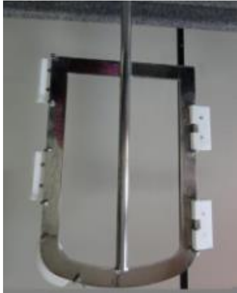
Figura 2.16: Impelidor âncora com raspadores
