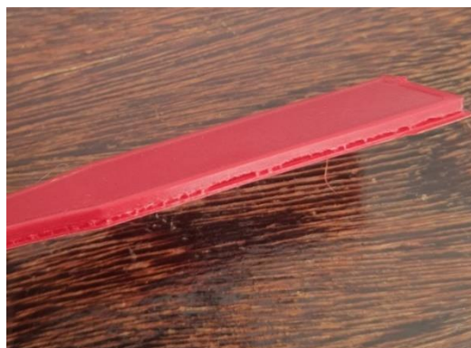
Figura 24: Desprendimento de algumas camadas na impressão em PETG
