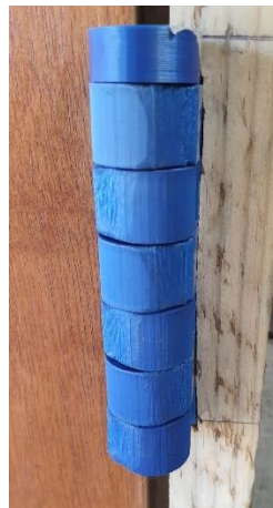
Figura 36: Visão posterior de uma dobradiça impressa e instalada
