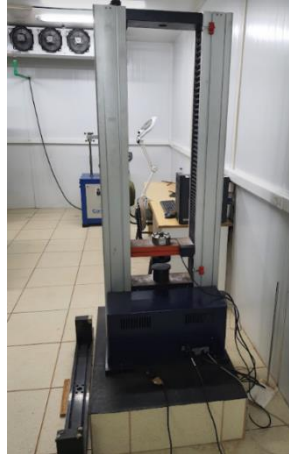
Figura 10: Máquina de ensaios universal cedida pela Universidade Federal de Lavras
