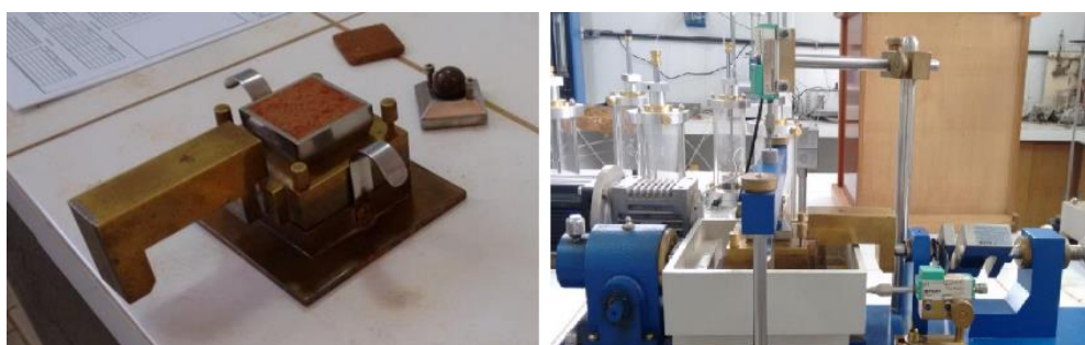
Figura 32 – Montagem do ensaio cisalhamento direto.
