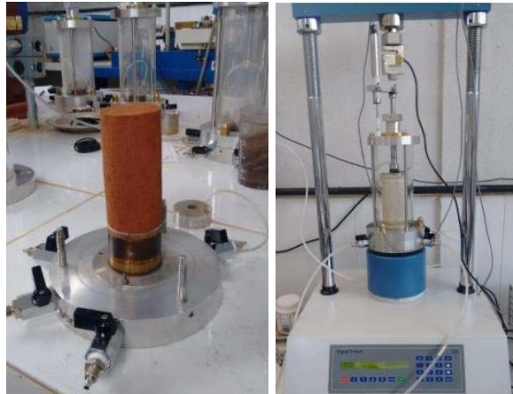
Figura 19 – Montagem do Triaxial.
