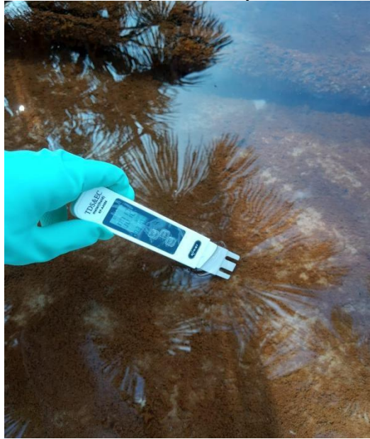
Figura 6 – Utilização do medidor multiparâmetro para análise da qualidade da água.
