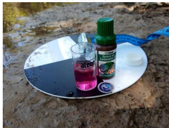
Figura 15 – Análise de dureza em carbonatos 10 ml.
