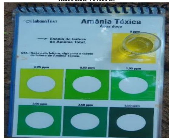
Figura 11 – Determinação dos valores de amônia tóxica.
