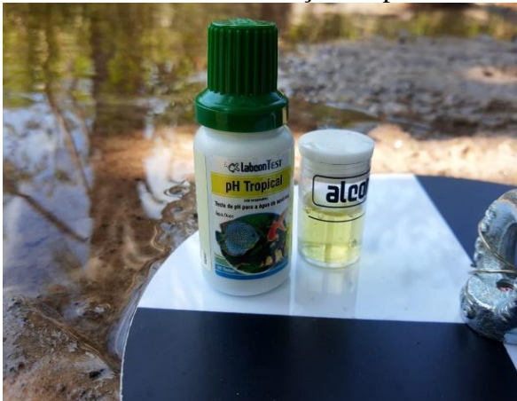
Figura 8 – Amostra e reagente para determinação do pH.
