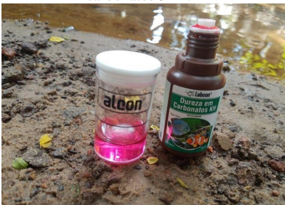
Figura 14 – Análise de dureza em carbonatos 5 ml.
