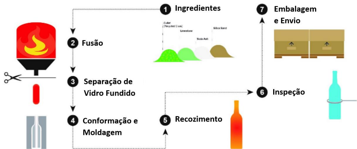
Figura 4 - Processo de fabricação do vidro
