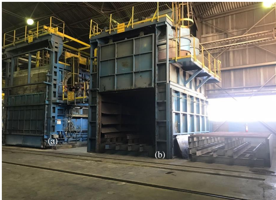
Figura 16 - Equipamentos usados no tratamento térmico: (a) forno de solubilização à resistência elétrica e (b) câmara de resfriamento.
