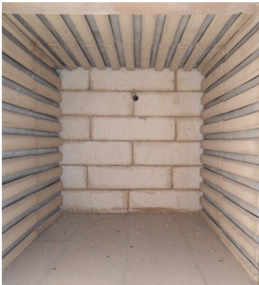
Figura 26 - Exemplo de estufa revestida com tijolo e manta cerâmica refratária.
