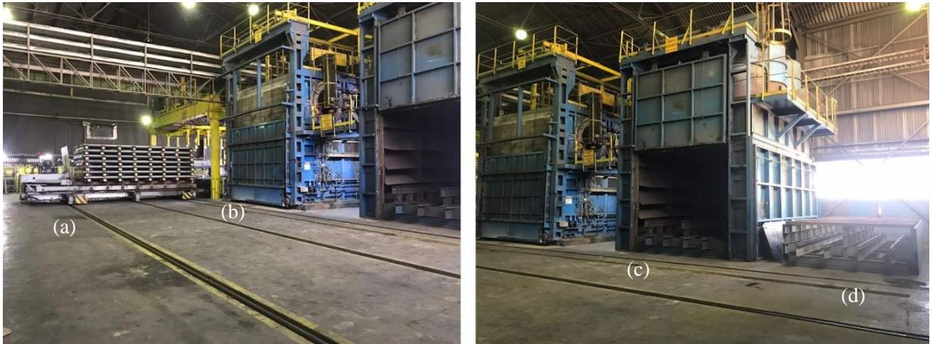
Figura 17 - Visão geral dos equipamentos envolvidos no tratamento térmico: (a) carro de locomoção de carga; (b) forno de homogeneização; (c) câmara de resfriamento e (d) estaleiro de espera.
