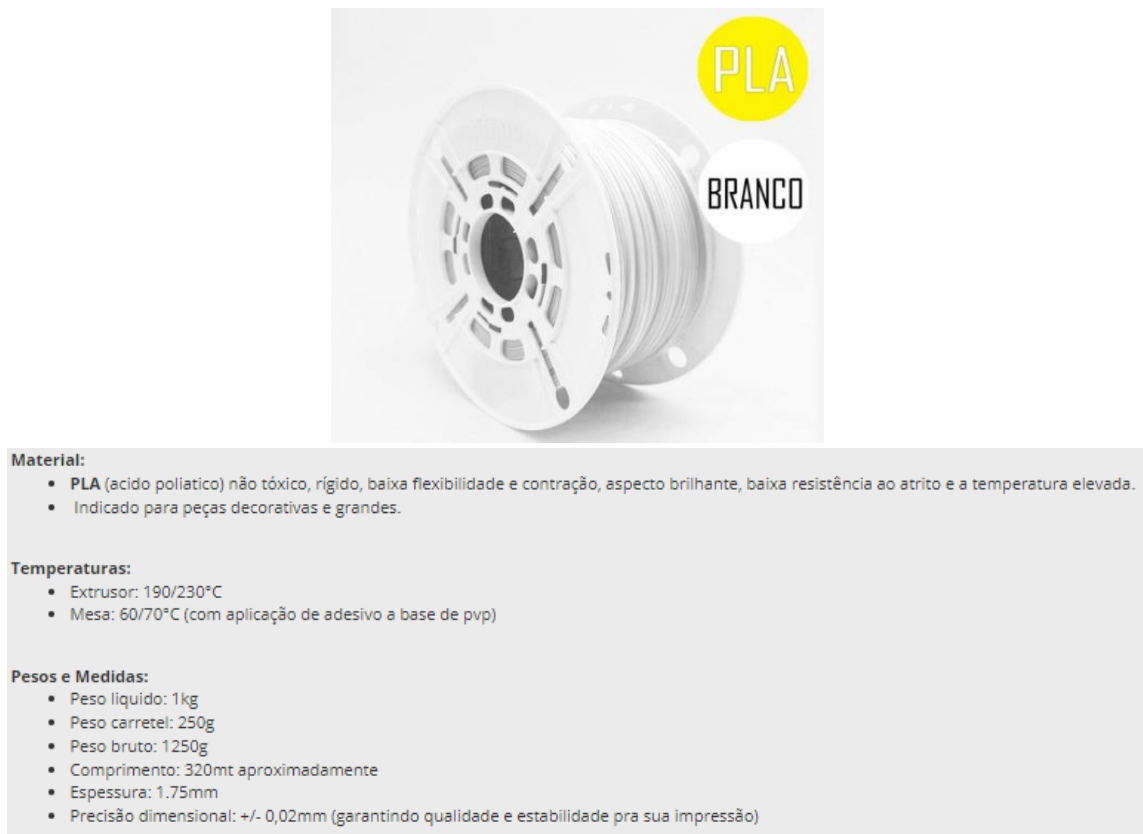
Figura 2.10 – Exemplo de filamento de PLA com suas características.
