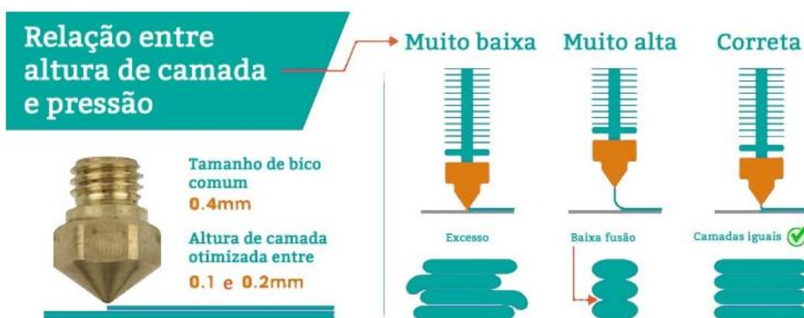
Figura 2.8 – Relação entre altura de camada e pressão
