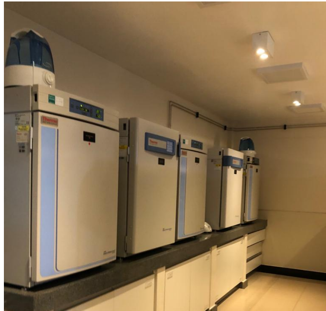
Figura 4 - Incubadoras com temperatura controlada e gases estabilizantes
