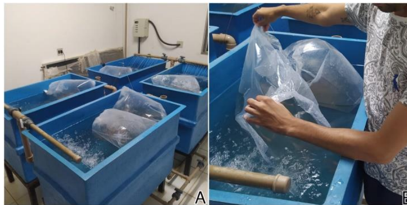
Figura 3 - Sacos inflados com oxigênio puro e amarrado com elástico já nas caixas de 500 litros (A); Sacos abertos e aos poucos inserindo os peixes no sistema (B).
