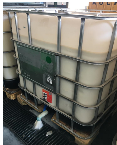
Figura 18 - Esgotamento do fundo para as canaletas
