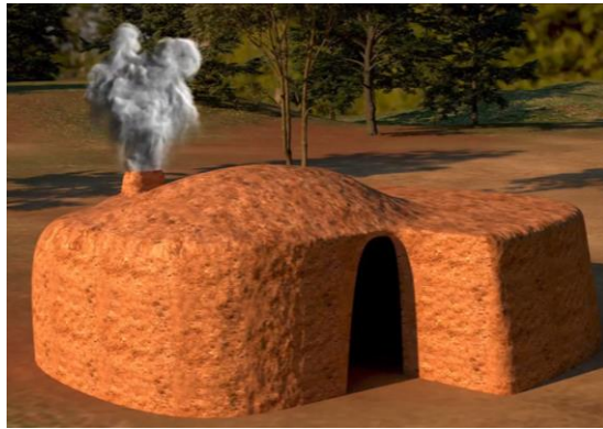
Figura 8 – Forno tradicional para produção de carvão vegetal.
