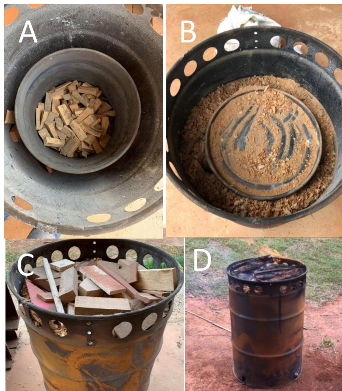
Figura 16 - Sistema do tipo forno-fornalha (A) cilindro interno preenchido com cavacos de madeira; (B) Área anelar preenchida com biomassa para a ignição; (C) tambor preenchido com material para a queima; (D) ignição do material.
