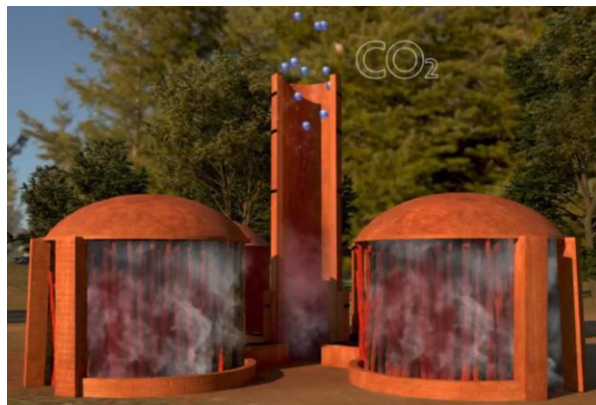
Figura 9 – Sistema forno-fornalha para produção de carvão vegetal.
