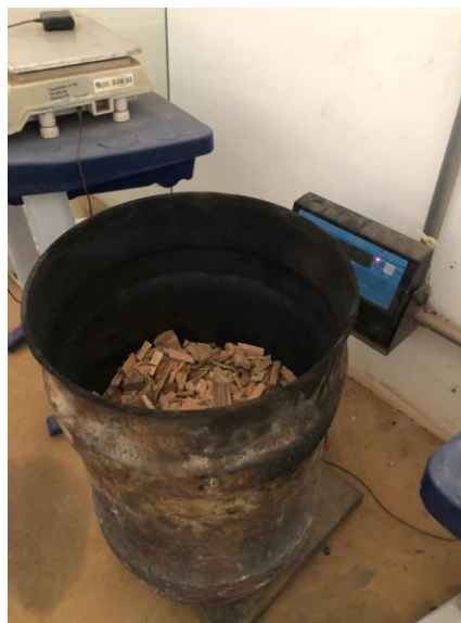
Figura 15 - Determinação da massa de cavacos de eucalipto.
