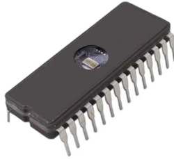
Figura 2.28: Pastilha de memória EPROM, com sua escotilha ao centro, pela qual é possível expor seus componentes à luz ultravioleta e conseqüentemente apagar os dados armazenados.
