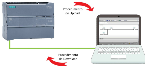
Figura 2.4: CLP conectado a um computador com a plataforma de desenvolvimento instalada. É possível realizar os procedimentos de download e upload , nesse caso, por meio da conexão feita com um cabo.
