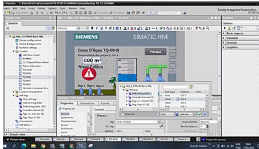
Figura 35 – Parametrização de variáveis no IHM
