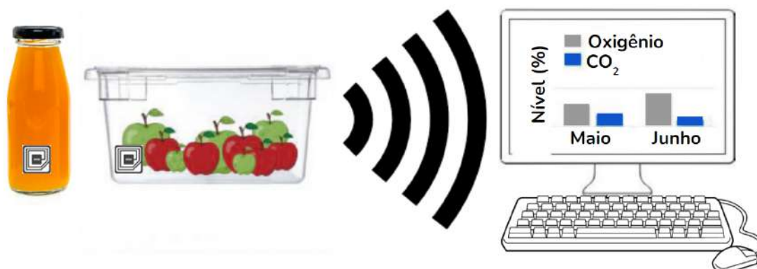
Figura 3 - Embalagens inteligentes baseadas na tecnologia RFID para controle de qualidade de alimentos.
